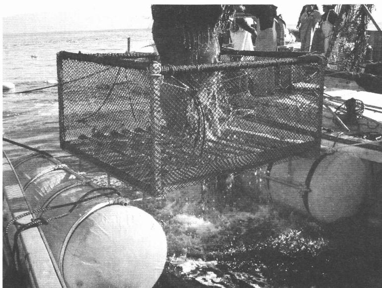
図3 クラゲスイーパーによる裁断試験
