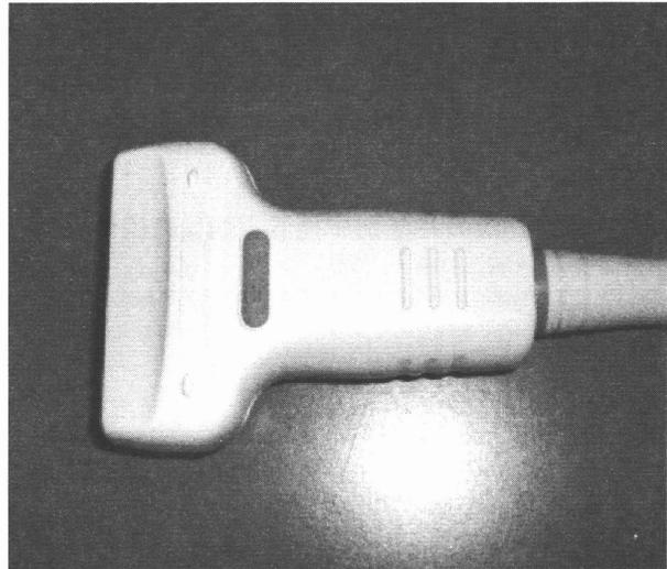
図2 電子リニア探触子(アロカ製UST-5524-7.5)
