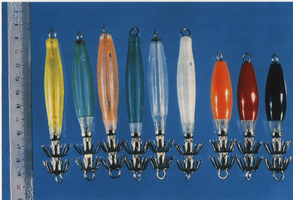
図3. 比較したソフト針(ケース長53mm)とベーク針(右3本, ケース長41mm)
