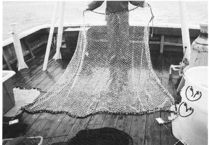
図1 放流トリガイの保護に用いたカバーネット (2m×2m, 鉛ラインロープ付)。
