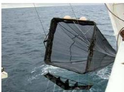
←MOHT（網枠の下に見えるのはディプレッサー 写真提供：安間洋樹）
